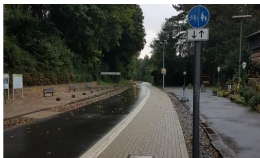
Abbildung 12 Selbstständiger Geh- und Radweg mit optisch kontrastierender taktile Trennung (Wuppertal Nordbahntrasse) (Foto: IVST)
